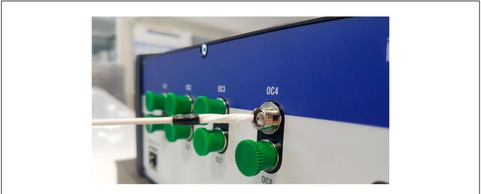
*Abb. 3.28* Reinigen der Anschlusskupplung des Interrogators
