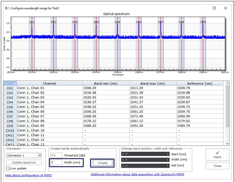
Abb. 4.10 Automatische Erkennung
