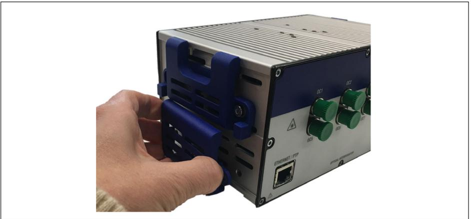
Abb. 3.14 Entfernen der unteren Abdeckung
