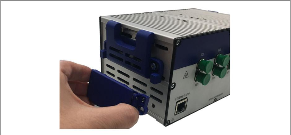
Abb. 3.15 Montieren des CASECLIP
