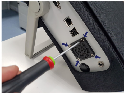
Fig. 3.15 Fixation du filtre du ventilateur
