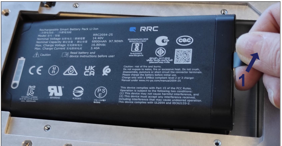
Fig. 3.9 Retrait du bloc-batterie
