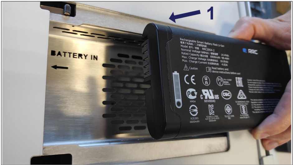
Fig. 3.10 Aligement du bloc-batterie
