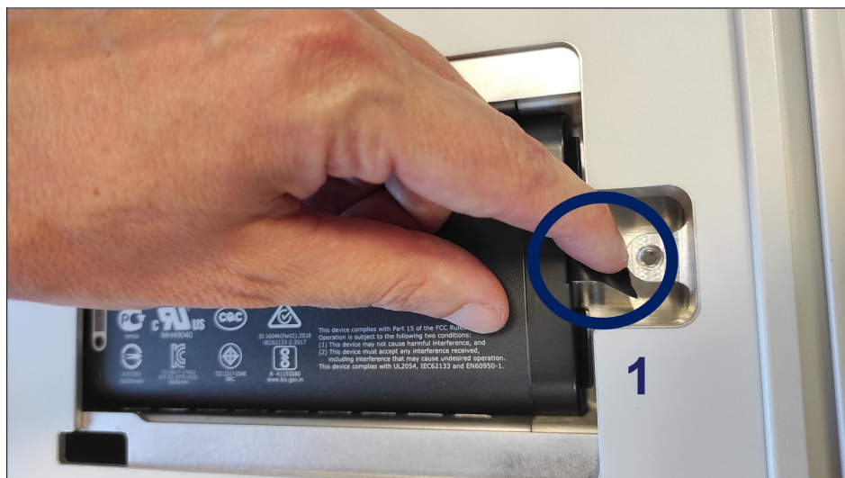
Fig. 3.11 Positionnement de la languette d'extraction
