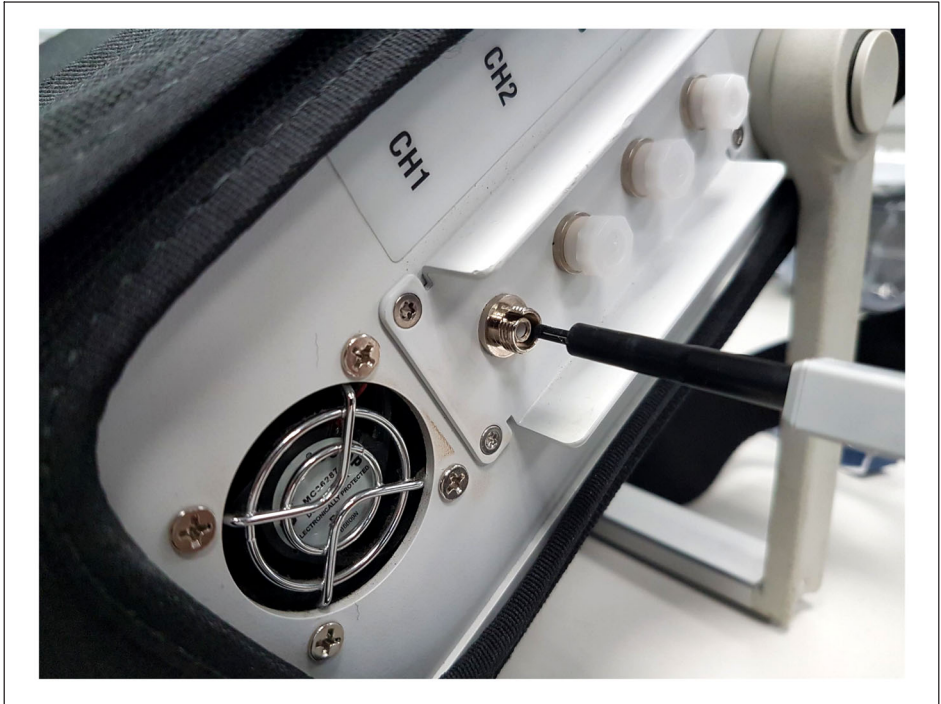
Fig. 4.7 Nettoyage de l'adaptateur
