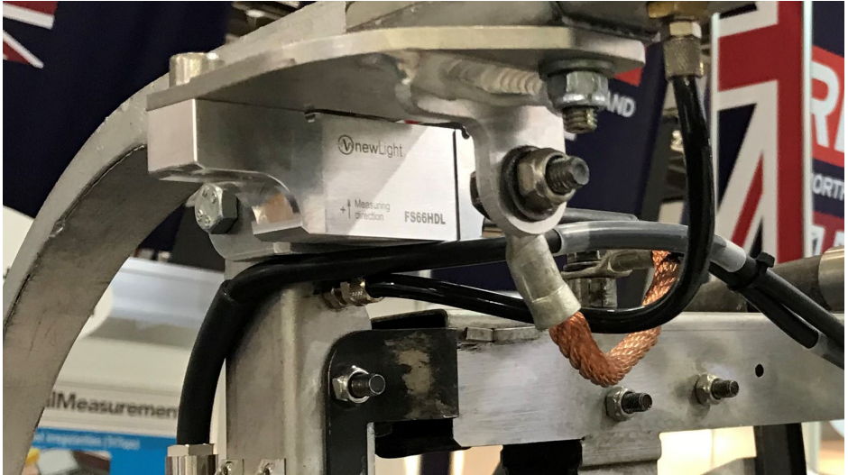
Fig. 3.5 Capteur de force FS66HDL monté sur un pantographe
