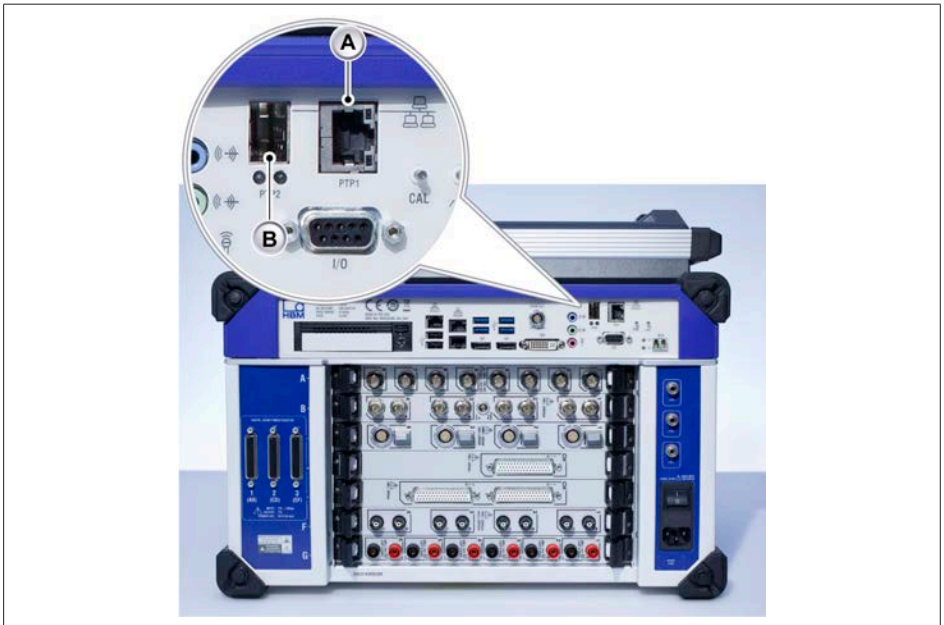
Fig. G.1 GEN7i PTP enabled ports
