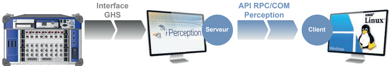
Figure 1.39 : Schéma de principe DCE/RPC
