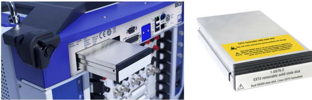
Figure 1.19 : Exemple de SSD dans un support de disques partiellement inséré dans le GEN7tA (à gauche) et SSD intégré dans un support de disques (à droite)
