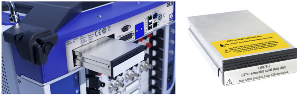
図 1.19: ドライブキャリアに収納された SSD を GEN7tA に装着 (左)、SSD をドライブキャリアの内側に組み込んだ例 (右)
