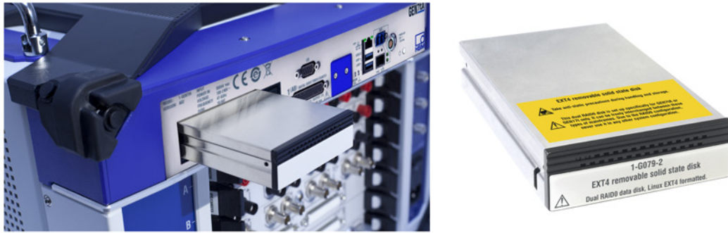
图 1.19: 驱动基底中 SSD 的样本部分进入 GEN7tA (左), 且 SSD 内建驱动基底 (右)
