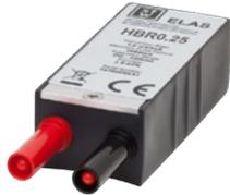
0,25 Ω, 1 W, alta precisione dello 0,02%, resistenza di carica a bassa deriva termica. Usa internamente un collegamento a 4 fili per ridurre l'imprecisione causata dalle correnti presenti sulla resistenza di carica. Usando spine di ingresso a banana e pin di uscita a banana. Direttamente compatibile con le schede d'ingresso GN610B/GN611B.  | Ordinato dai sistemi specifici dei clienti <sup>(1)</sup> |
