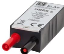
0,5 Ω, 1 W, alta precisione dello 0,02%, resistenza di carica a bassa deriva termica. Usa internamente un collegamento a 4 fili per ridurre l'imprecisione causata dalle correnti presenti sulla resistenza di carica. Usando spine di ingresso a banana e pin di uscita a banana. Direttamente compatibile con le schede d'ingresso GN610B/GN611B. | Ordinato dai sistemi specifici dei clienti <sup>(1)</sup> |
