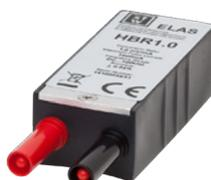
1 Ω, 1 W, alta precisione dello 0,02%, resistenza di carica a bassa deriva termica. Usa internamente un collegamento a 4 fili per ridurre l'imprecisione causata dalle correnti presenti sulla resistenza di carica. Usando spine di ingresso a banana e pin di uscita a banana. Direttamente compatibile con le schede d'ingresso GN610B/GN611B.   | Ordinato dai sistemi specifici dei clienti <sup>(1)</sup> |
