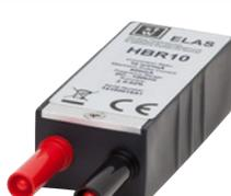
10 Ω, 1 W, alta precisione dello 0,02%, resistenza di carica a bassa deriva termica. Usa internamente un collegamento a 4 fili per ridurre l'imprecisione causata dalle correnti presenti sulla resistenza di carica. Usando spine di ingresso a banana e pin di uscita a banana. Direttamente compatibile con le schede d'ingresso GN610B/GN611B.  | Ordinato dai sistemi specifici dei clienti <sup>(1)</sup> |
