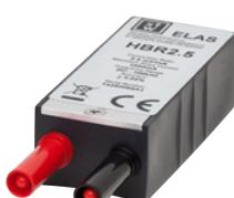
2,5 Ω, 1 W, alta precisione dello 0,02%, resistenza di carica a bassa deriva termica. Usa internamente un collegamento a 4 fili per ridurre l'imprecisione causata dalle correnti presenti sulla resistenza di carica. Usando spine di ingresso a banana e pin di uscita a banana. Direttamente compatibile con le schede d'ingresso GN610B/GN611B. | Ordinato dai sistemi specifici dei clienti <sup>(1)</sup> |
