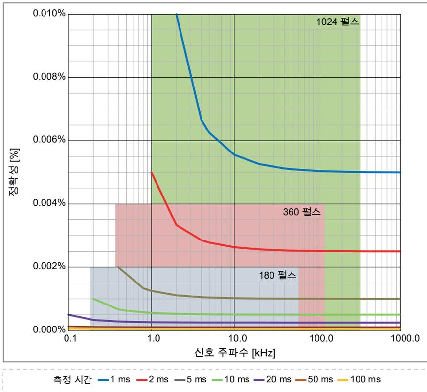
그림 28: RPM 센서 작동 범위 대 부정확 및 측정 시간
