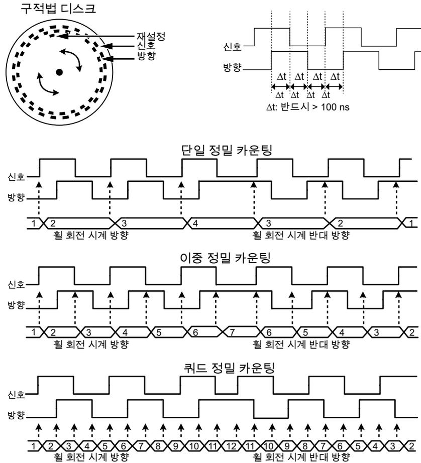
그림 24: 양방향 구적법(quadrature) 카운트 모드
