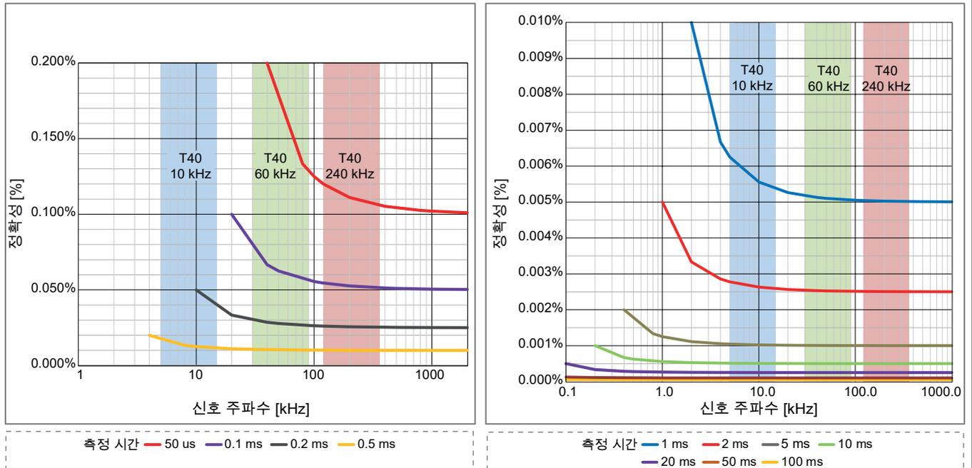
그림 27: 토크 작동 범위 대 부정확 및 측정 시간
