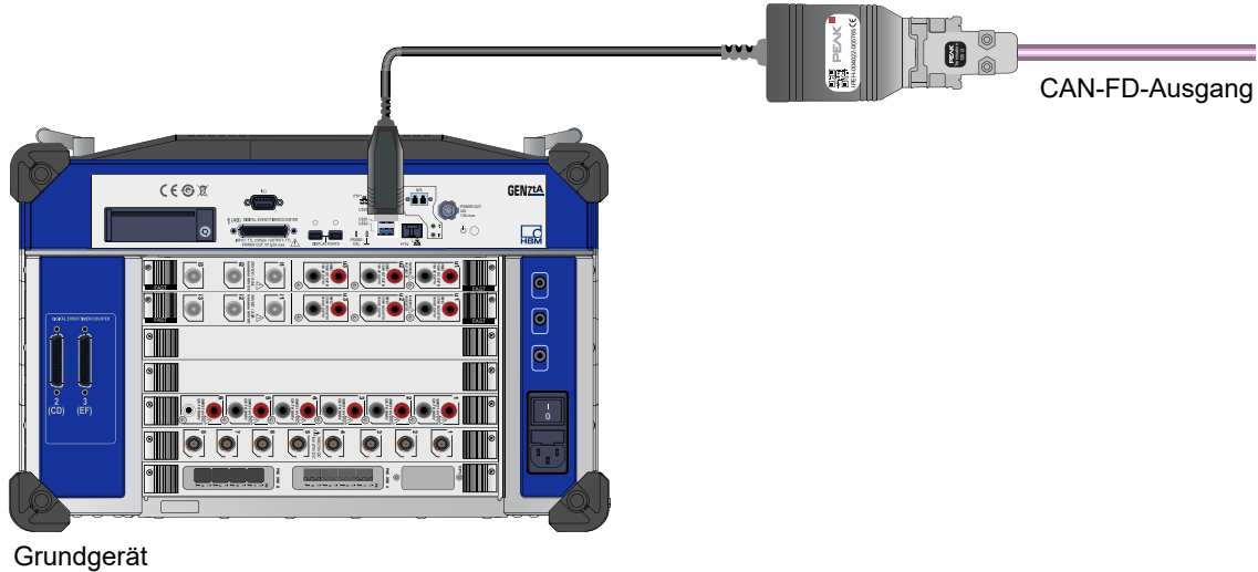
Abbildung 1.27: GEN7tA mit autarker Ausgabe über CAN FD
