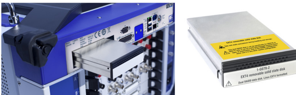
Figura 1.19: Esempio di SSD nel portaunità inserito parzialmente nel GEN7tA (a sinistra) e SSD integrato nel portaunità (a destra)
