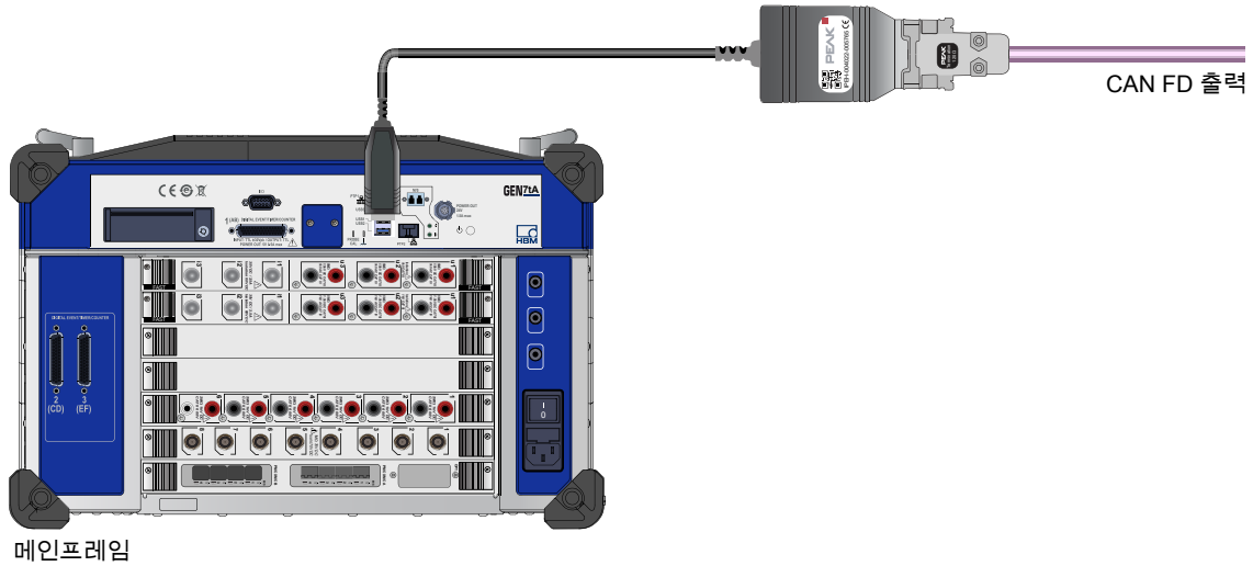
그림 1.27: GEN7A 독립형 CAN FD 출력
