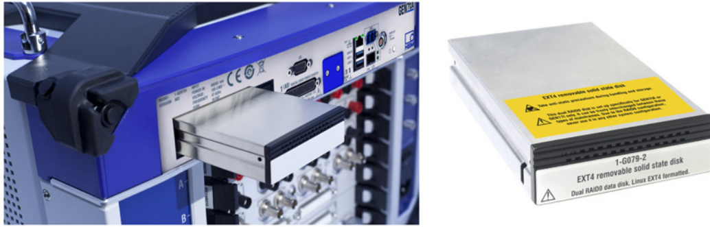
그림 1.19: GEN7tA 에 일부 들어가 있는 드라이브 캐리어 안 SSD (왼쪽)와 드라이브 캐리어 안에 내장된 SSD (오른쪽)
