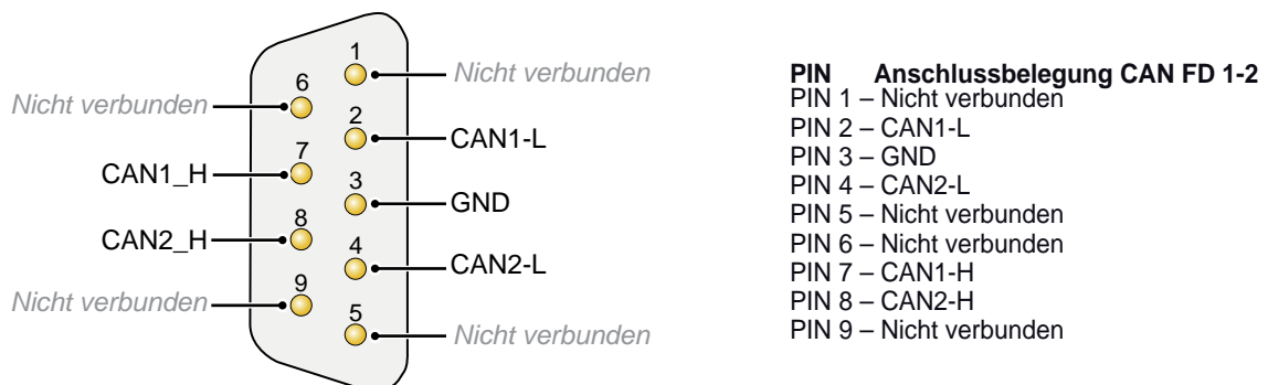
Abbildung 24: Anschlussbelegung der CAN-FD-Option
