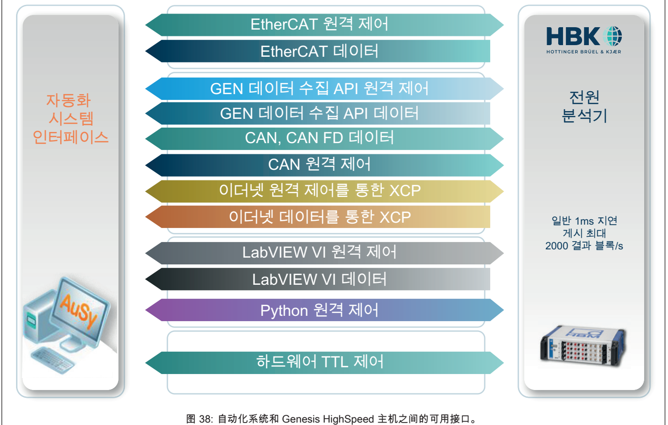
图 38: 自动化系统和 Genesis HighSpeed 主机之间的可用接口。
