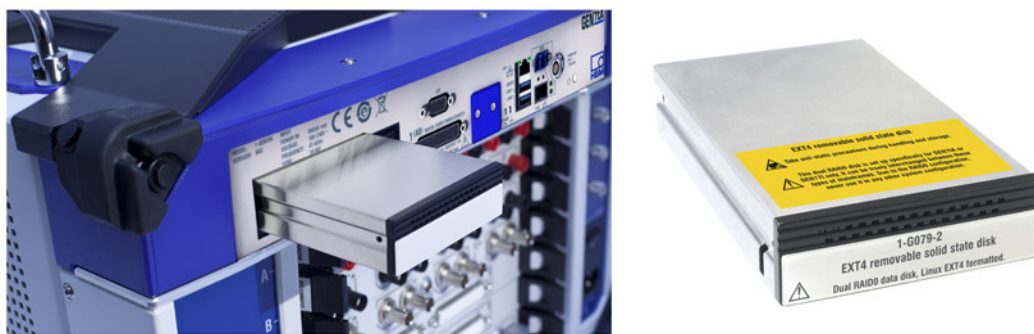
Figura 1.18: Esempio di SSD nel portaunità inserito parzialmente nel GEN7tA (a sinistra) e SSD integrato nel portaunità (a destra)
