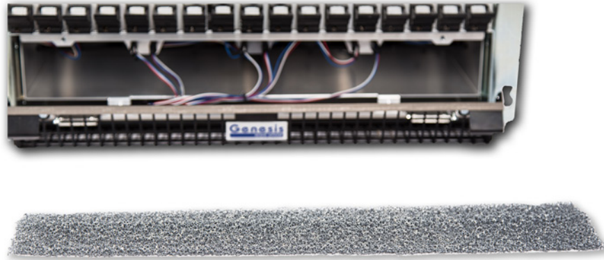
Figura 1.16: Fácil acceso para limpiar/sustituir el filtro de aire
