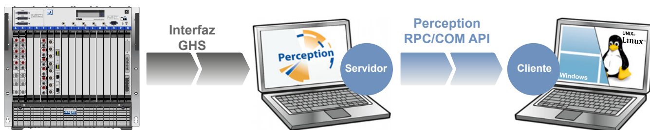
Figura 1.42: Diagrama funcional de DCE/RPC
