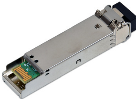
图 1.25: 10 Gbit 光学网络 SFP 模块 1310 nm
