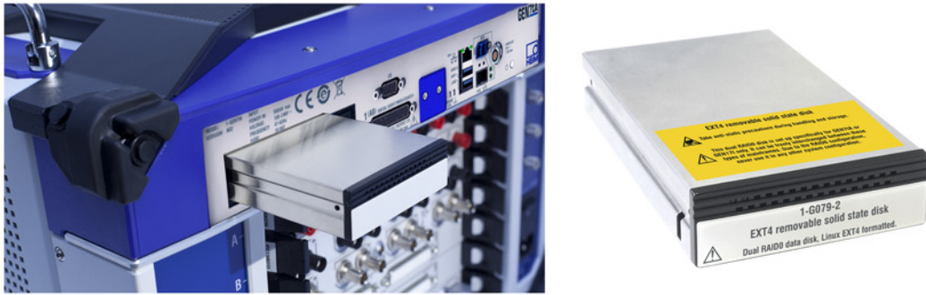
图 1.18: 驱动托架内的 SSD 部分插入 GEN7tA 示例（左）和驱动托架中的内置 SSD 示例（右）
