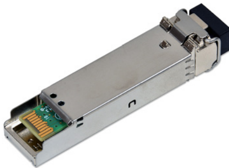
图 1.24: 10 Gbit 光学网络 SFP 模块 850 nm
