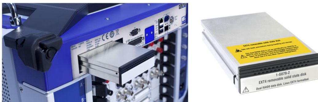
図 1.18: ドライブキャリアに収納された SSD を GEN7tA に装着 (左)、SSD をドライブキャリアの内側に組み込んだ例 (右)
