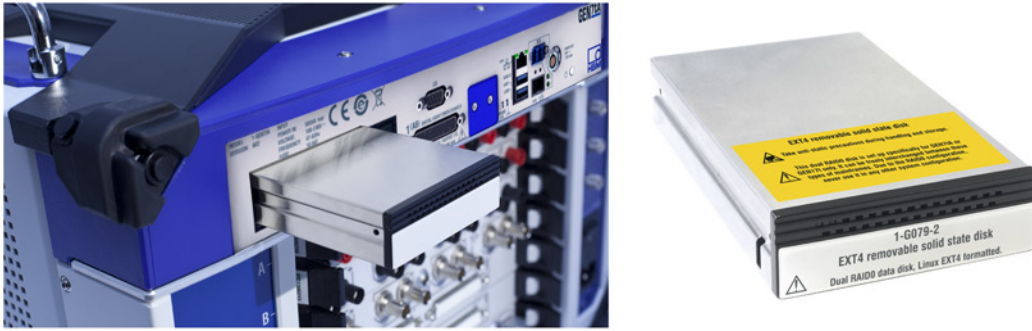
그림 1.18: GEN7tA 에 일부 들어가 있는 드라이브 캐리어 안 SSD (왼쪽)와 드라이브 캐리어 안에 내장된 SSD (오른쪽)
