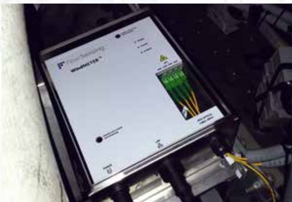
Interrogator WindMETER im Betrieb in einer Windkraftanlage
