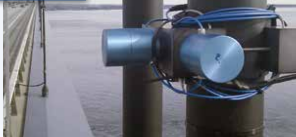
光ファイバ式センサによるグレートベルト橋の振動計測 (デンマーク)
