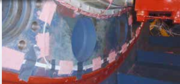
発電機に設置された光ファイバ式温度センサ
