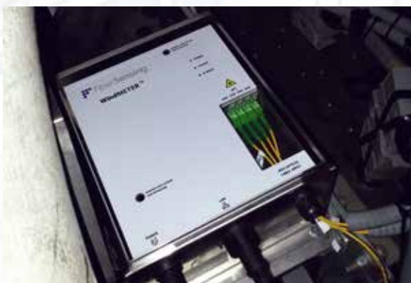
風力タービンの運用に使用されるWindMETERインテロゲータ
