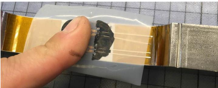
8. Belassen Sie die Fluorpolymerfolie als Trennfolie auf dem ungehärteten Klebstoff.
