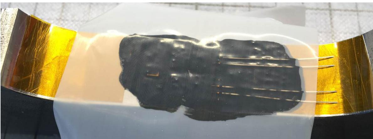
11. Aushärtung: Die Aushärtezeit des 3M DP490 beträgt bei Raumtemperatur 35 Stunden. Sie können die Aushärtezeit durch Wärmeeinwirkung verkürzen.
