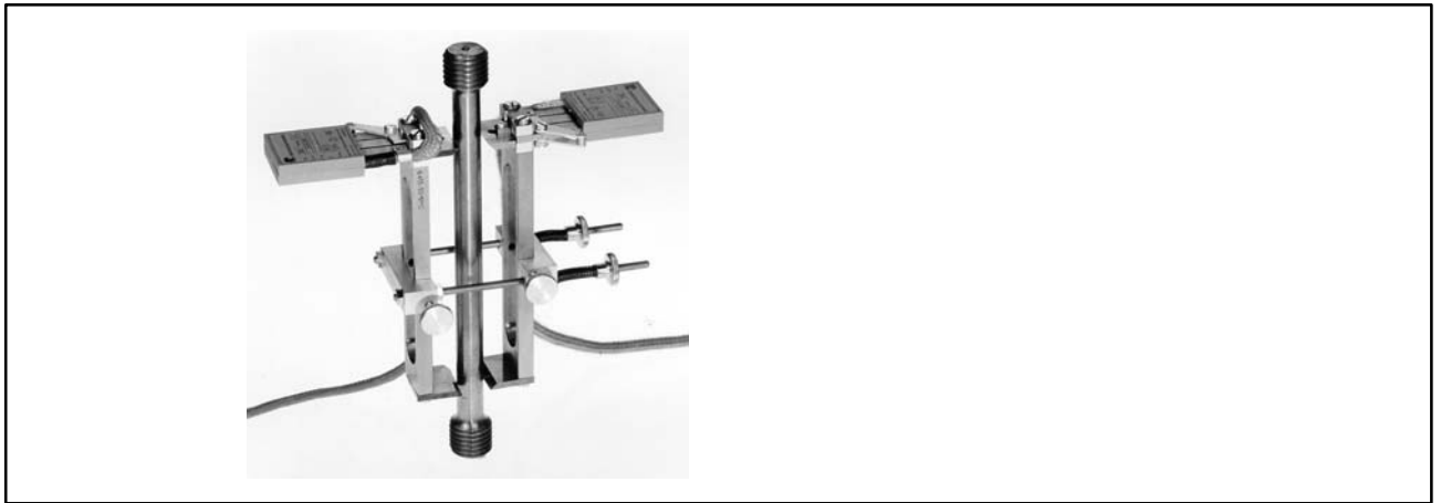
Abb. 3.2: Zwei gegenüberliegend angeordnete Anklemm-Dehnungsaufnehmer DD1 ZA
