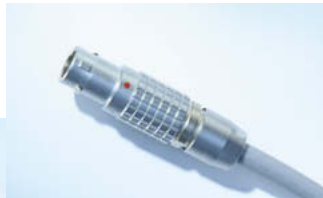
Lemo-Steckverbinder FGG 6-polig, Schutzart IP 67 für Kabeldurchmesser 3,1...6mm
