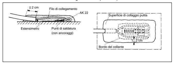
Fig. 4.1: Punto di misura ER rivestito con AK22
