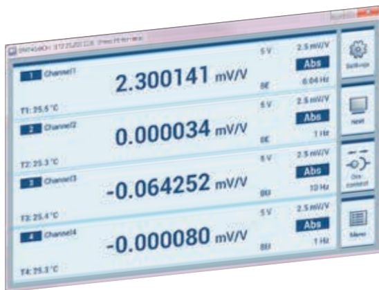
Messung von bis zu vier Temperaturen als Hilfsgrößen parallel zu den DMS-Signalen
