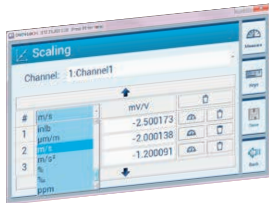
Umwandlung der elektrischen Größe (mV/V) in physikalische Einheiten (z.B. kg, N, Nm, Pa) für jeden Kanal individuell durch Linearisierung von 2...11 Stützpunkten
