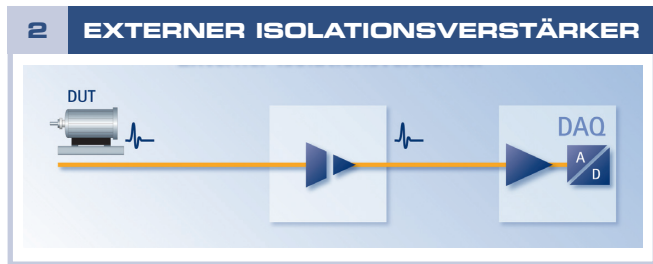
Bild 2. Das DAQ-System kann weiterhin genutzt werden, und Trennverstärker sind kostengünstig zu haben
