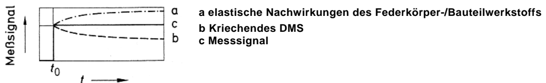
Bild 3.3-31: Schema der Kriech-Kompensation
