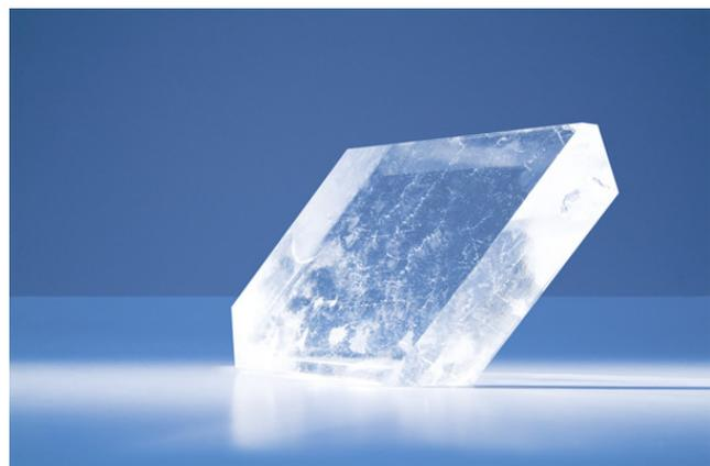
*Fig. 2: Il fosfato di gallio ( $\text{GaPO}_4$ ) si distingue per la sua elevata stabilità a lungo termine*
