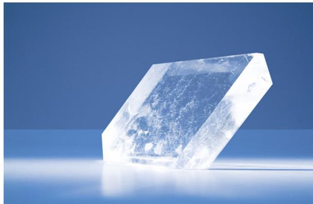
**Fig. 2: O Fosfato de Gálio ( $GaPO_4$ ) se distingue por sua altíssima estabilidade a longo prazo**
