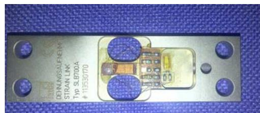
*Bild 3: Federkörper des SLB: Deutlich zu erkennen die Dehnzone, in der der DMS installiert ist*
