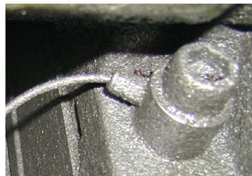
*Bild 6: Ein Kraftmessring misst die auf eine Verschraubung wirkenden Kräfte zur Werkzeugüberwachung.*
