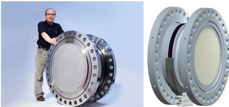
Bild 5: Realisierung eines 1,5 MN·m-Aufnehmers und Designvorschlag
