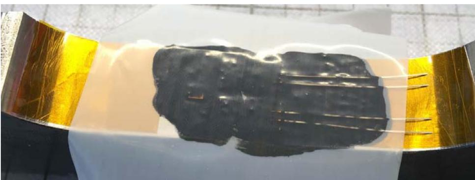
11. Aushärtung: Die Aushärtezeit des X120 beträgt bei Raumtemperatur 35 Stunden. Sie können die Aushärtezeit durch Wärmeeinwirkung verkürzen.
