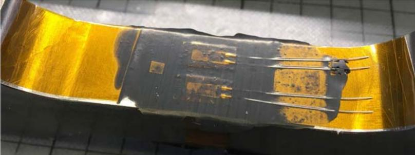
12. Verwenden Sie eine Pinzette, um die Anschlussbändchen aus dem Klebstoff X120 herauszulösen und sie an externen Lötstellen festzulöten.
