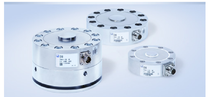
Abb. 3: Radialsymmetrischer Scherkraftaufnehmer C10 für Druckkräfte. Versionen mit angeschraubten Fußadapter (links) und als Messflansch (Sensoren auf der rechten Seite)
