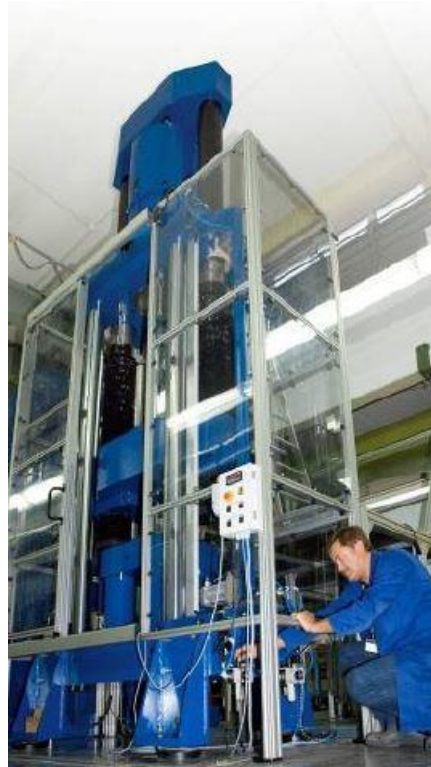
HBM Germania Macchina idraulica di taratura delle forze con trasduttore di riferimento con carico nominale 5 MN
