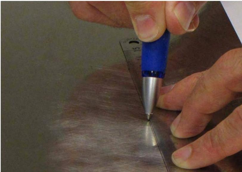
Fig. 2.1 Tracciatura delle linee di marcatura
