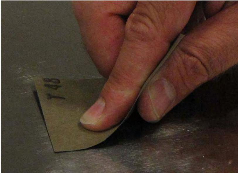
Fig. 1.3: Irruvidimento della superficie del corpo di misura
