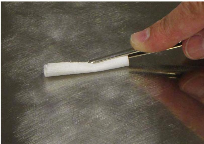
Fig. 1.4: Pulitura della superficie di installazione irruvidita
