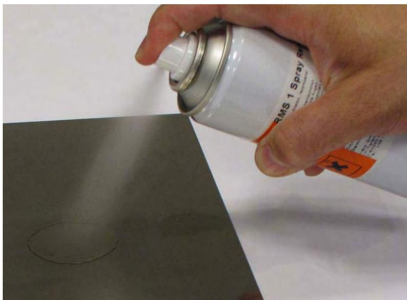
Fig. 1.1: Pulitura a spruzzo del punto di misura con 1-RMS-SPRAY
