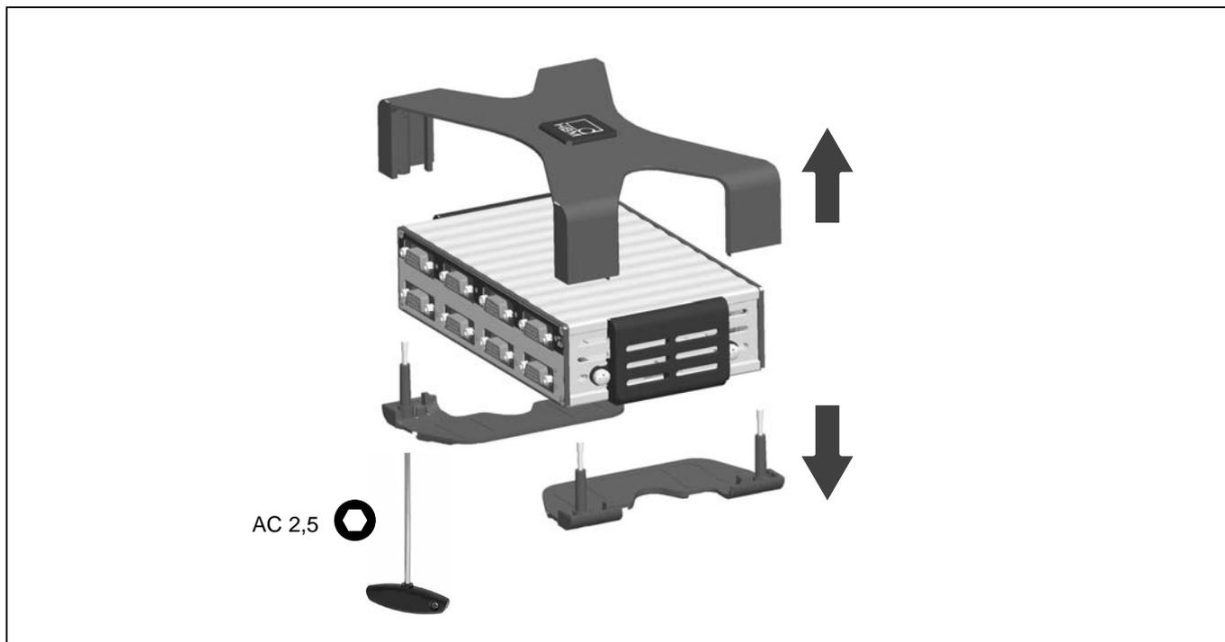
**Fig.1:** Rimozione della protezione della custodia (solo per grado di protezione IP 20)
