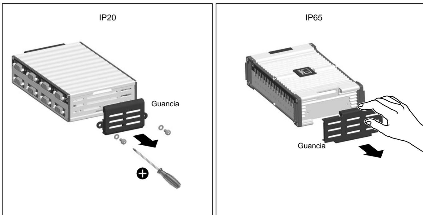
**Fig.2:** Rimozione delle guance
