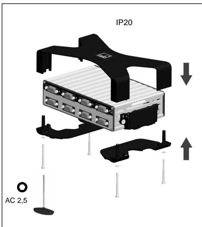
**Fig.4a:** Montaggio della protezione custodia (solo IP 20)
