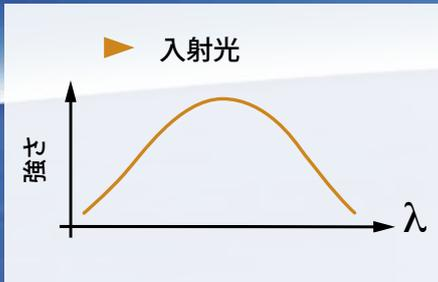
レーザー光源が特定の波長範囲、例えば1510nmから1590nmの範囲、の光をファイバ内へ入射します。
