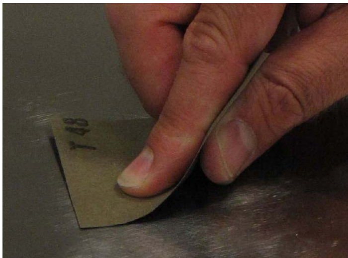
図 1.3 : 計測体の表面を粗面化する
