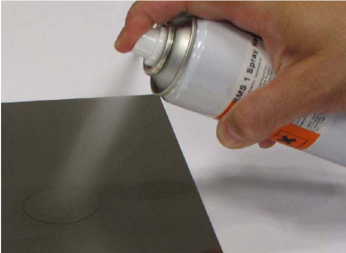
図 1.1 : 1-RMS-SPRAY を使用して計測ポイントにスプレーする
