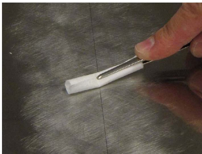
図 2.2 : 取り付けポイントの最終清掃
