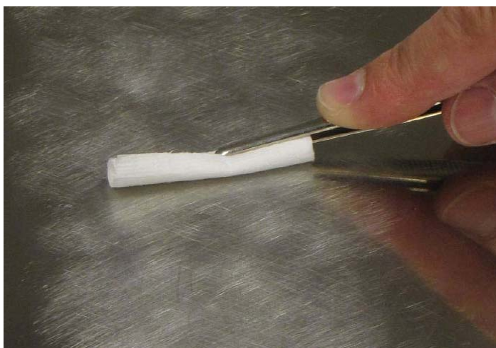
図 1.4 : 粗面化の済んだ取り付け面の清掃
