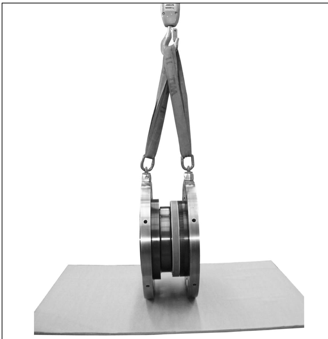
図 4.4: 水平設置するためにロープで結びつける
