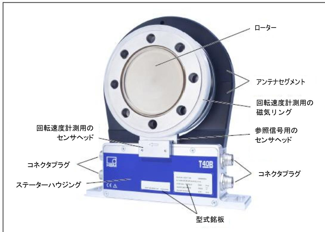
図 3.3 : 機械の構造 (回転速度計測システムおよび参照信号 (ゼロ指標) 用のセンサヘッドを装備)
