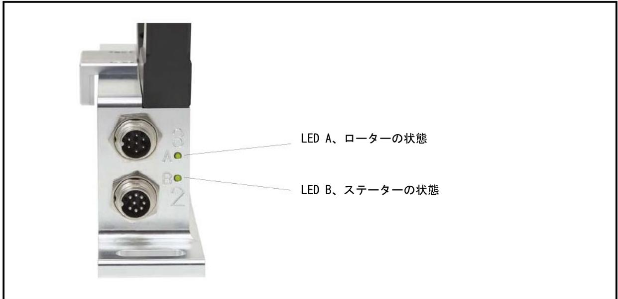
図7.1：ステーターハウジング上のLED
