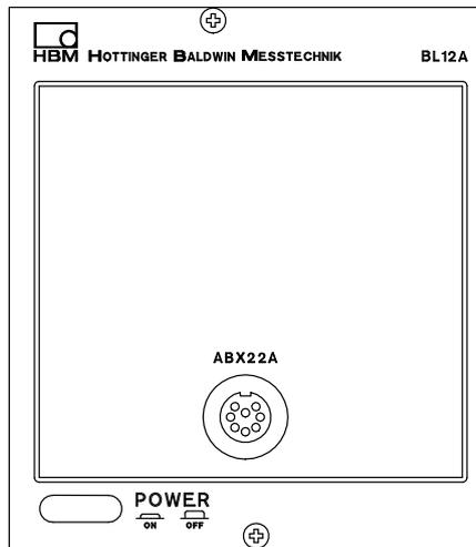
Conecte el enchufe de la unidad móvil de visualización y control ABX22A a la toma de corriente de la placa protectora BL12A.
