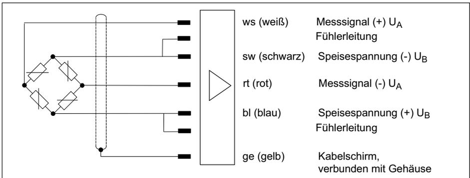
Abb. 7.2 Aufnehmer mit vieradrigem Anschlusskabel, Messverstärker in Sechisleiter-Technik
