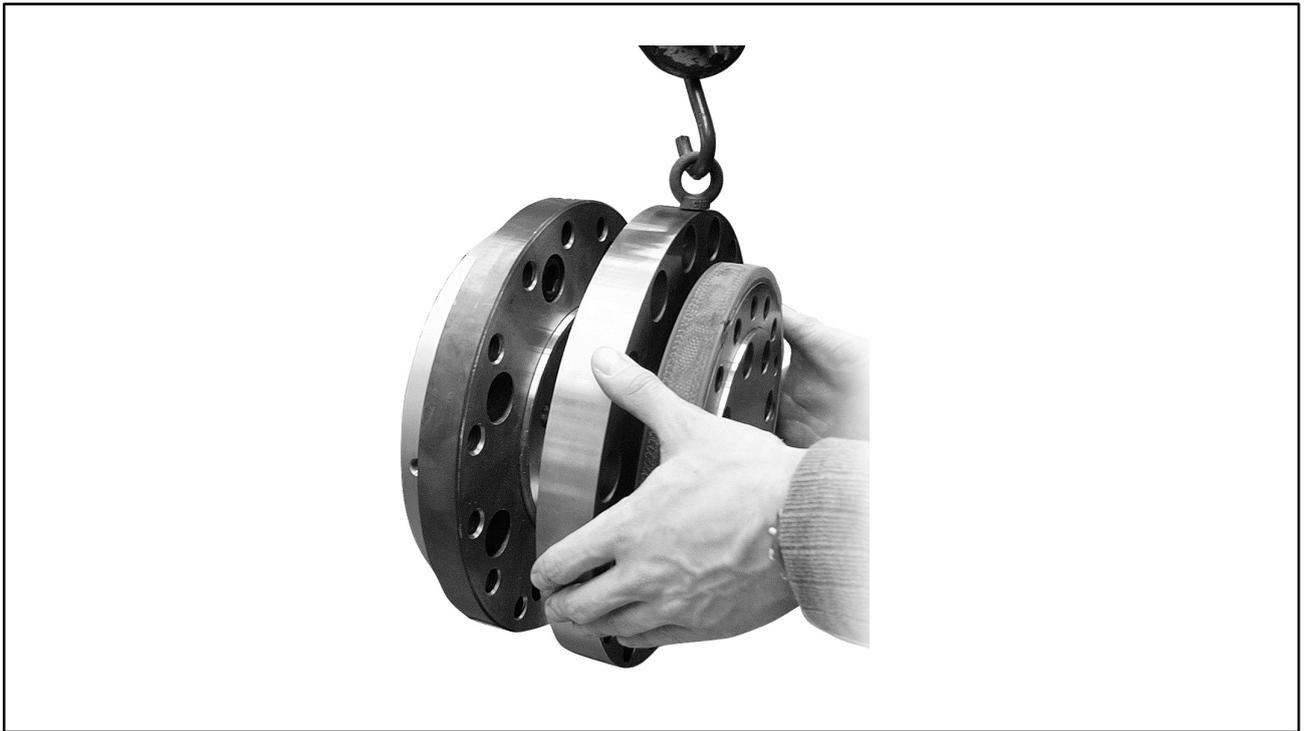
Abb. 4.3: Rotoreinbau (waagrecht)
