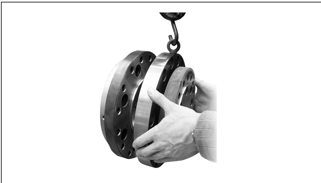
Fig. 4.3: Montage du rotor (installation d'axe horizontal)
