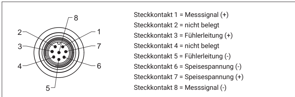
Abb. 5.1 Steckerbelegung
