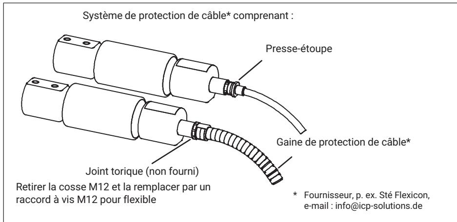
Même sans système de protection de câble, les pesons standard atteignent le degré de protection IP68/IP69K. Pour les applications où le câble PUR du peson peut être attaqué ou détruit par voie chimique ou mécanique, il est possible d'ajouter une protection supplémentaire grâce à des systèmes de protection de câble disponibles dans le commerce.
