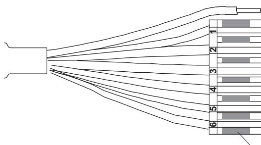
Schirm (gelb) = Kabelschirm mit Wägezellenkörper verbunden
