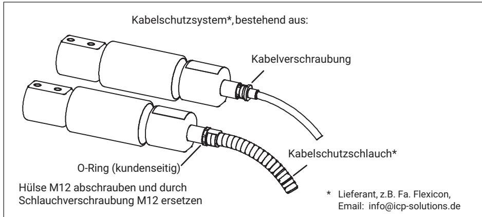
Auch ohne Kabelschutzsystem wird bei den Standardwägezellen die Schutzart IP68/IP69K erreicht. In Anwendungsfällen, bei denen das PUR-Kabel der Wägezelle chemisch oder mechanisch angegriffen oder zerstört werden kann, ist es möglich, das Kabel mittels handelsüblicher Kabelschutzsysteme zusätzlich zu schützen.
