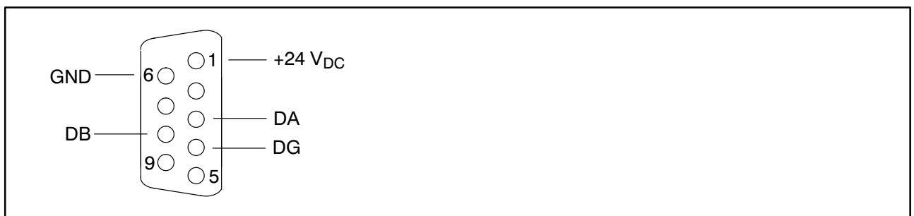
Abb. 6.1: Steckerbelegung CC-Link-Schnittstelle, D-Sub-Buchse 9-polig (Stiftausführung), Ansicht auf Kontaktseite
