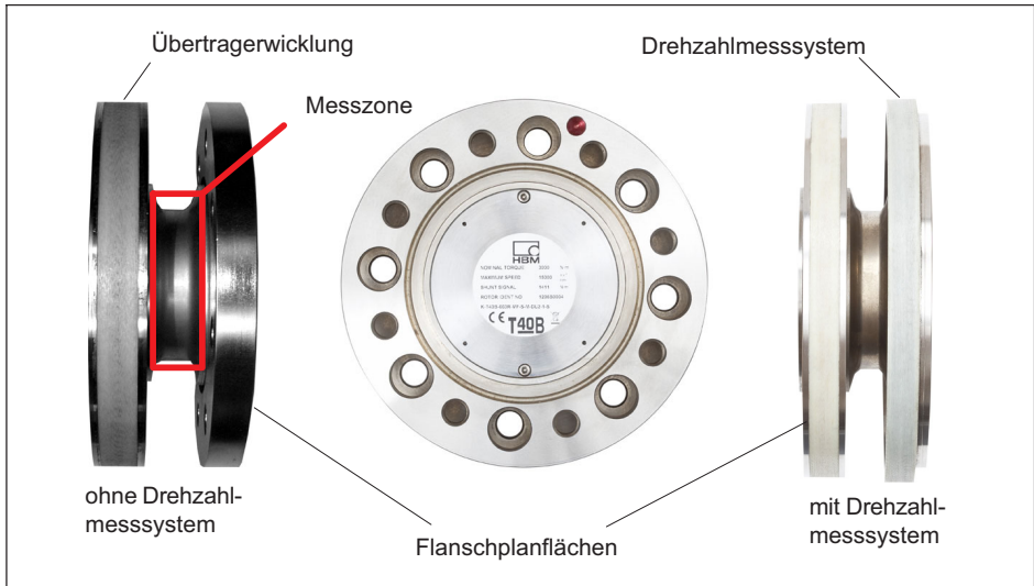
Abb. 5.1 Verschraubung des Rotors
