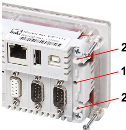
Fig. 3: Arrière du WE2111, cache du bouton de configuration étant retiré.
