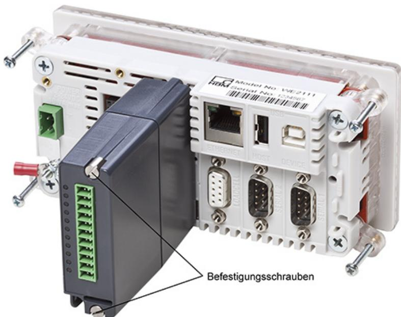
Abb. 5: Ansicht von hinten, Befestigung optionaler Module
